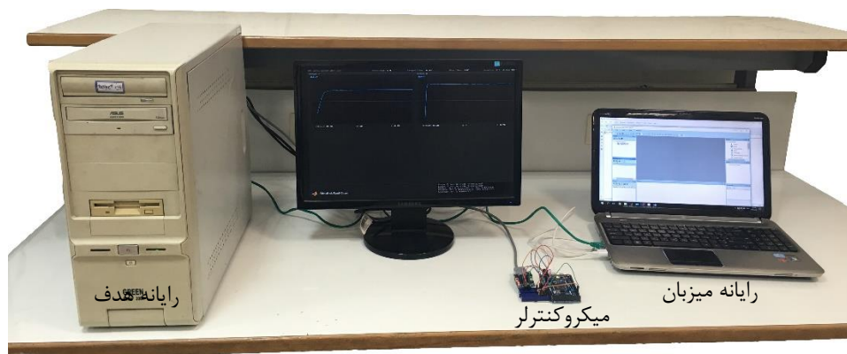
شکل ۳.۸ پیاده‌سازی زمان حقیقی فیلتر چندمدلی کالمن توسعه یافته به منظور تخمین مدل باد.
