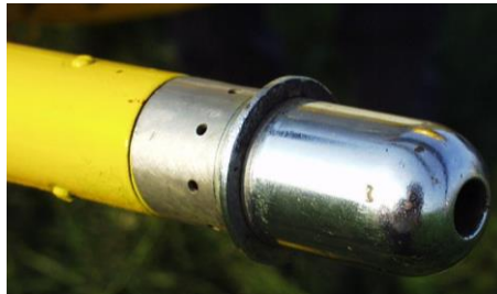
شکل ۷.۲ نمایی از لوله پیتوت [۲۳].
